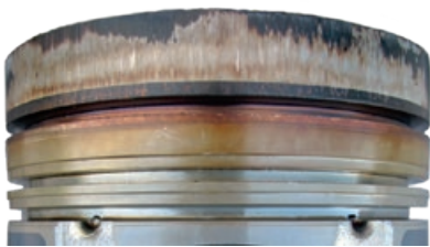
Sondergasanwendung nach > 10.000 Bh mit GMO 240
